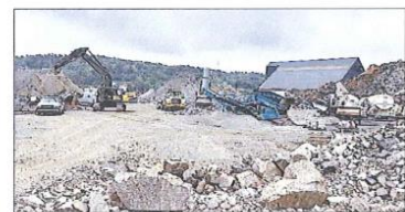
KNUSER: Klodeborg og Landvik pukker sprenger ned fjellet på Eydehavn og knuser det til puk og grus.
